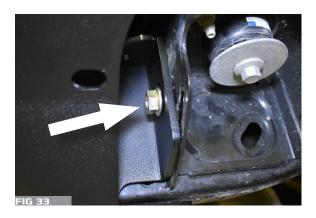
15. RE-INSTALL FACTORY HITCH, FITTING BETWEEN BUMPER AND REAR CROSS-MEMBER. USE THE OPENING IN THE REAR BUMPER TO INSTALL THE 4 FACTORY BOLTS. FIG. 34, 35
